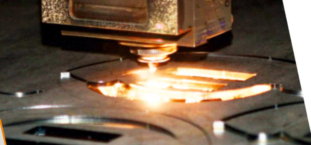
Изготавливается на итальянской технологической линии, состоящей из станков лазерной резки, высокоточной гибки и роботизированной сварки, что обеспечивает высокую точность раскроя, 100%-ную собираемость, надежность сварочных швов.
