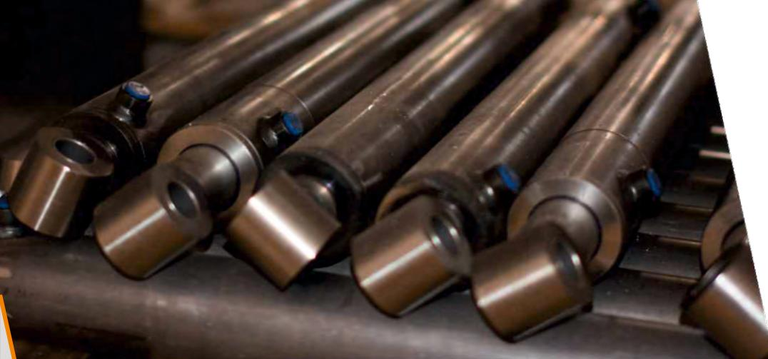
В гидроцилиндрах используются импортные штоки с хромовым покрытием толщиной 25 мкм, что предотвращает ржавчину, образование пятен выкрашивания на поверхности и износ, гильзы с хонингованной поверхностью, уплотнительные соединения и грязесъемники с улучшенным профилем, которые обеспечивают длительную работу цилиндров.
