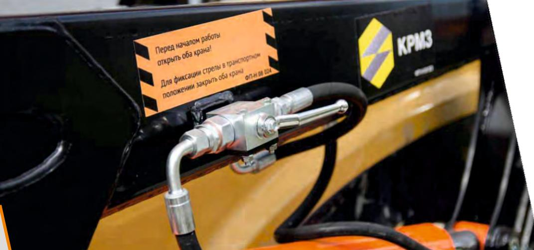
Система Self Leveling позволяет сохранять заданное положение и наклон рабочего инструмента или груза при подъеме и опускании. Позволяет сохранять груз во время подъема стрелы на одном уровне, что особенно удобно при погрузке-разгрузке палет, рулонов сена, исключает высыпание из ковша сыпучих грузов и т. д.
