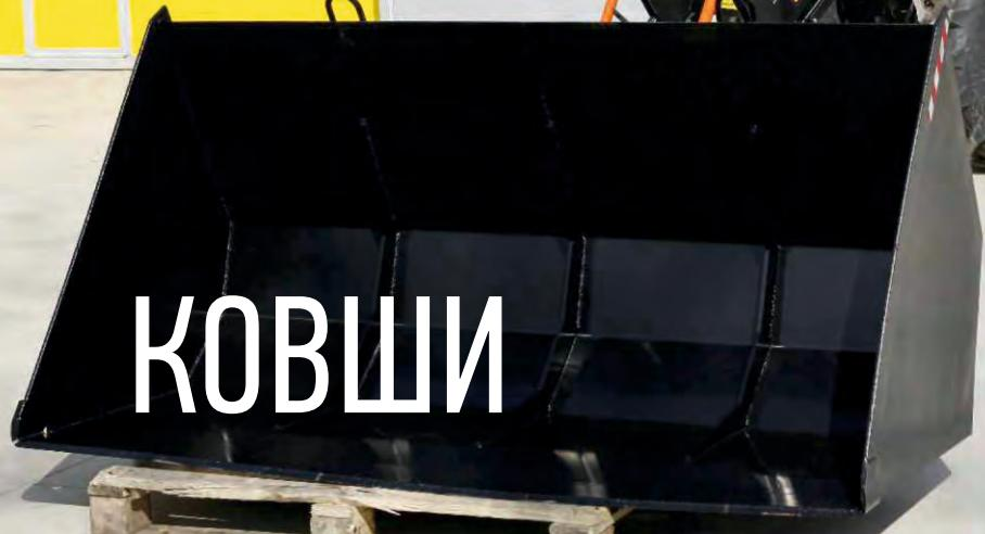
Ковши имеют исполнение как для сыпучих грузов малой весовой плотности, так и для работы с тяжелыми грузами. Дно ковша обладает дополнительными поперечными усилениями для предотвращения прогиба. По периметру ковш имеет боковые усиления для еще большей жесткости. Передняя режущая кромка выполнена из износостойчивой стали. Верхняя стенка двойного профиля для большей прочности и устойчивости при кручении. Точная геометрия благодаря лазерному раскрою. 3 вертикальных усиления внутри ковша.
